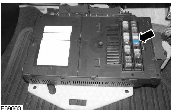
14. 安装保险丝23（燃油泵继电器）并关闭中央连接盒（CJB）。
